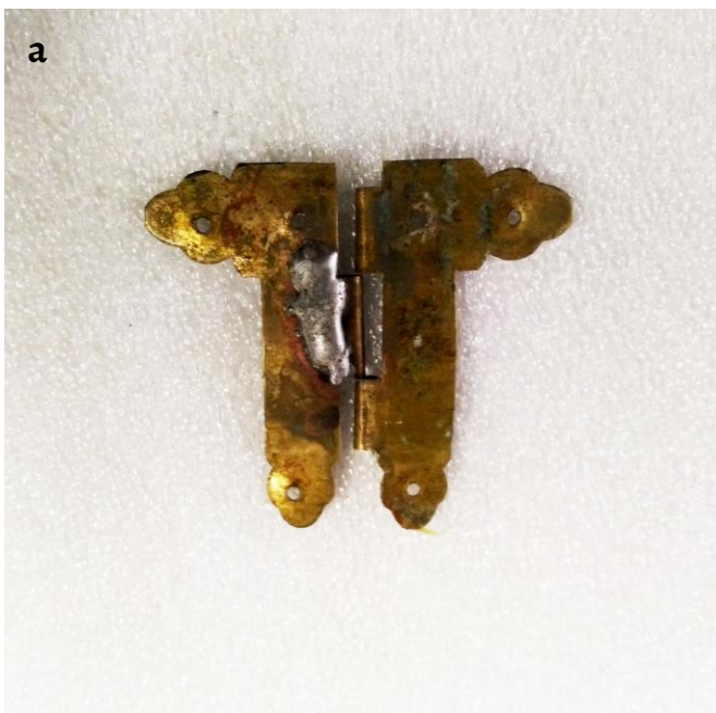
Figura 8. Dobradiça: a) solda e enchimento a estanho; b) soldada “a estanho” aplicada.
