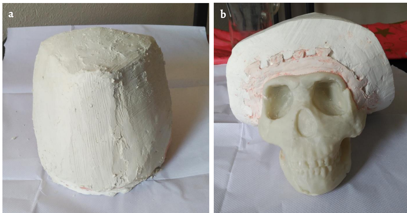
Figura 6. Realización del contramolde de escayola, carcasa de escayola de la primera parte del molde vista desde: a) la parte posterior y b) de frente; (fotos: M. Ávila Rodríguez).
