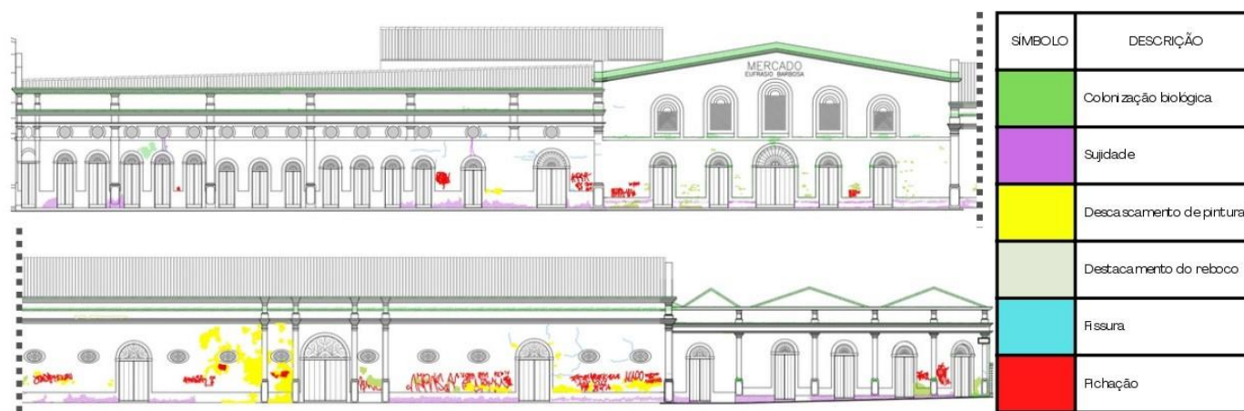
Figura 9. Mapeamento de danos realizado em janeiro de 2012.
