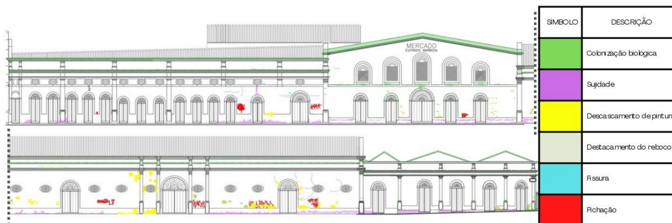
Figura 7. Mapeamento de danos realizado em janeiro de 2010.
