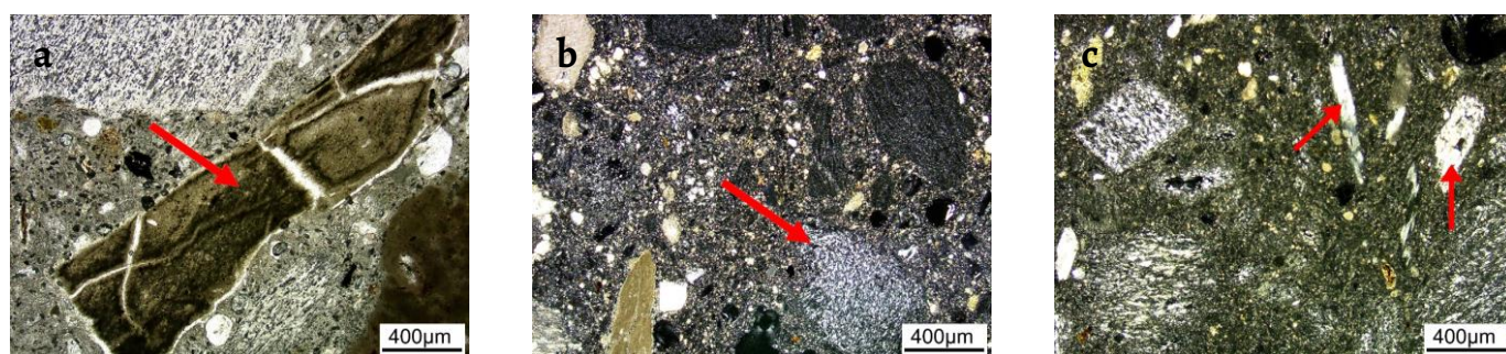
Figura 9. Imágenes del microscopio petrográfico: a) Muestra MP3, detalle de fragmento cerámico; b) Muestra MP3, detalle de cristales de anhidrita parcialmente rehidratada; c) Muestra MP5, muestra la presencia de cristales de anhidrita.
