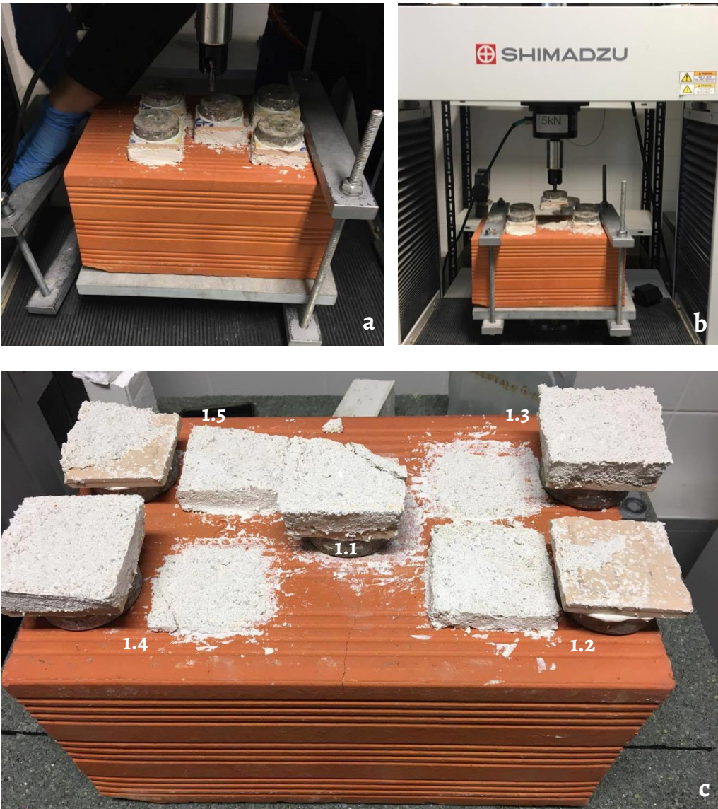
Figura 9. Ensaio de aderência ao suporte: a) e b) colocação no equipamento para realização do ensaio; c) após realização do ensaio.
