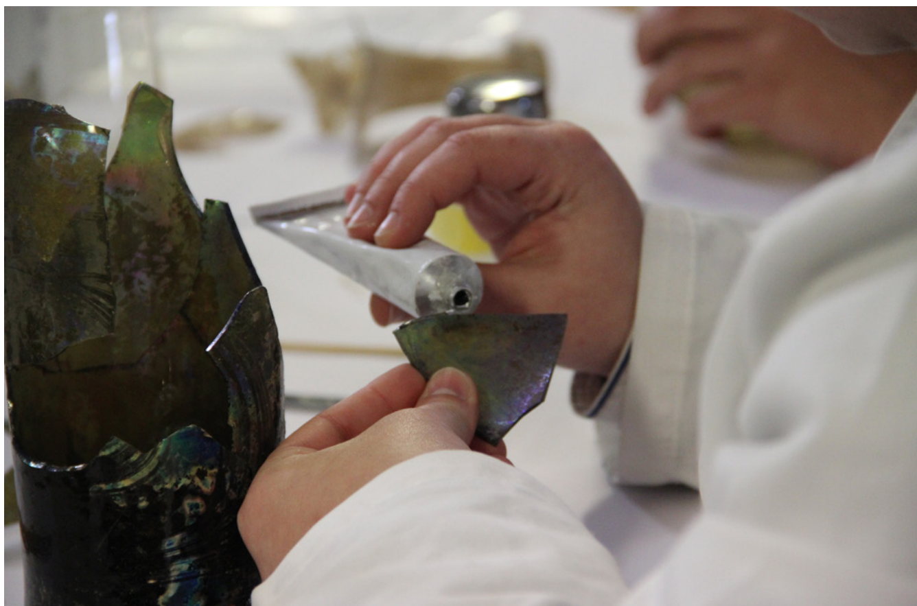
Figura 15. União de fragmento com recurso ao adesivo PB72 diluído a 40 % em acetona (v/v).
