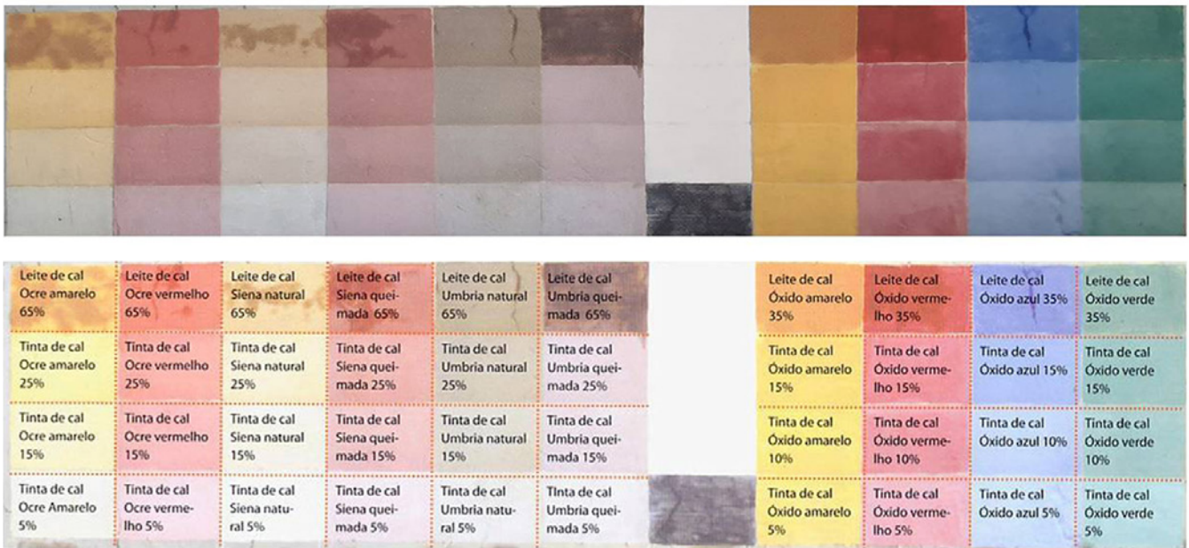
Figura 7. Ensaios de pintura ao traço volumétrico 1:3 (cal em pasta:água) e com pigmentos a 5, 15, 25 e 65 % em relação ao peso da cal em pasta ativada com 62,5 g de sal de alumínio. Esta formação teórico-prática foi realizada em 2005 no âmbito do programa Restauronet , tendo sido organizada pela Direção Geral dos Edifícios e Monumentos Nacionais (atual DGPC) em parceria com a École d'Avignon e a Câmara Municipal de Beja [32].
