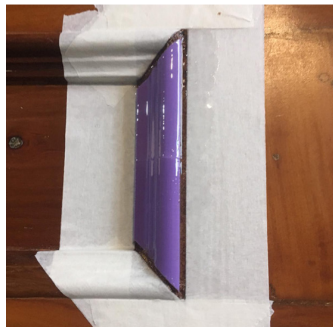
Figura 11. Registro do segundo teste: aplicação de resina sobre prótese com adição de pó de serragem nos vãos do seu entorno (foto: Tatiana Penna).
