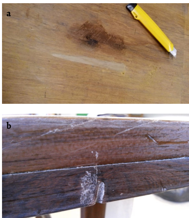
Figura 1. a) etapa de calefação com massa produzida com seladora e b) pó de lixamento da madeira de jacarandá (fonte: Acervo IFB, 2018).
