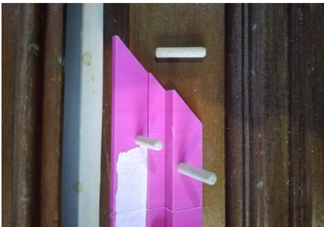
Figura 9. Fixação das cavilhas de madeira na prótese em 3D (foto: Ciro Martins).
