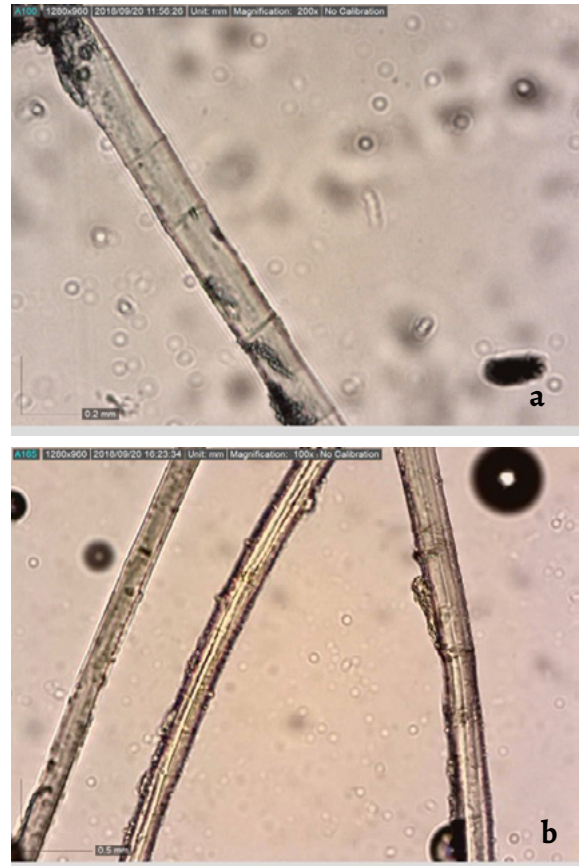
Figura 4. Análise de fibras: a) Amostra F1 (200 \times ) com corante Lofton-Merritt: pormenor dos nodos de ligação; b) Amostra F2 (100 \times ) com corante Herzberg: pormenor dos nodos de ligação e estrias longitudinais.
