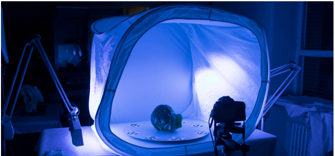
Figura 4. Escena para la toma de datos fotogramétricos del modelo seleccionado con fluorescencia visible inducida por UV (E. Sterp Moga).
