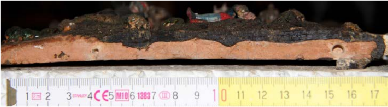
Figura 4. Amostragem ao corpo cerâmico na base do alto-relevo correspondente à Figura 2b. Amostragem micro-invasiva e não visível na exposição do alto-relevo (amostra #245).
