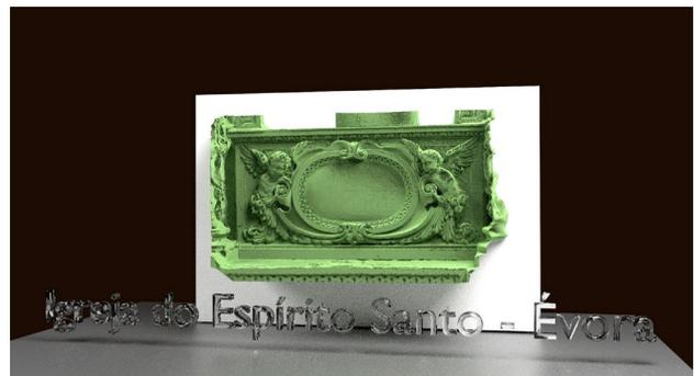
**Figura 8.** Representação gráfica 3D da cartela da Figura 7, sem informação de cor. Neste caso, não se representa a cor original da cartela, mas sim uma falsa-cor, onde se pretende salientar a informação do relevo superficial.
