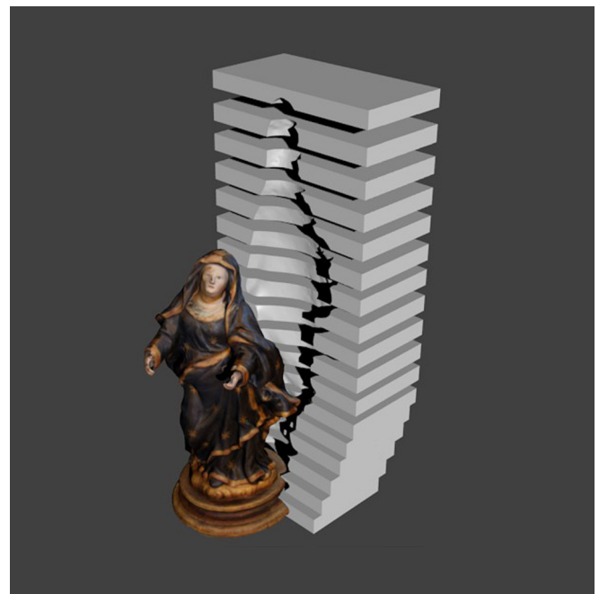
Figura 10. Infografía de embalaje por plantillas rígidas. Desarrollo de la mitad de las distintas partes que comprenderían el embalaje interno.
