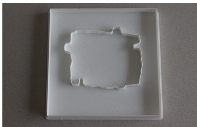
Figura 15. Estrutura de acondicionamento em PLA. Impressa no ProjectLab da Faculdade de Belas-Artes da Universidade de Lisboa, produzida por João Rocha, a partir do modelo tridimensional da autoria de Frederico Henriques. Fotografia de Ana Sofia Neves.
