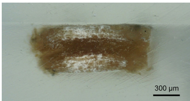
Figura 2. Corte estratigráfico do papel perfurado observado no microscópio óptico.
