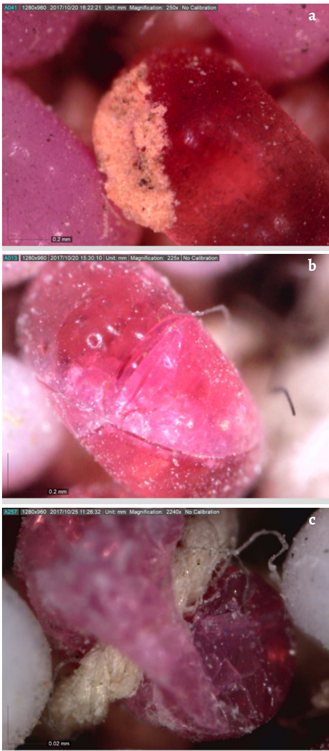
Figura 6. Depósito superficial (a), fractura (b) e lacuna (c) em missangas vermelhas transparentes observados com microscópio de mão.
