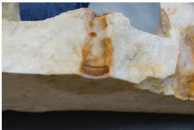
Figura 6. Tonalidade do mármore 1 mm abaixo da superfície tratada.
