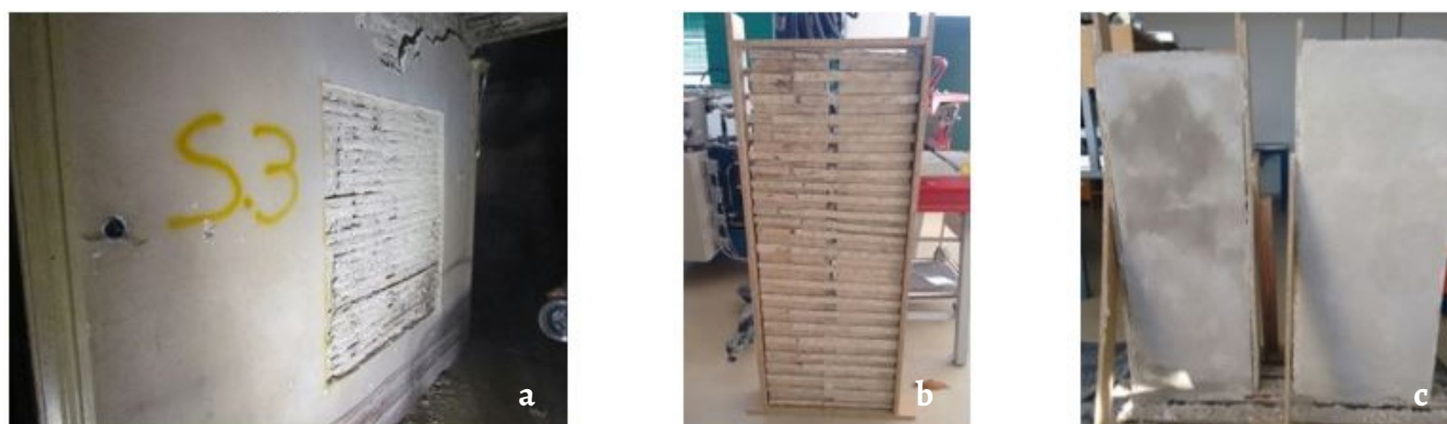
Figura 1. Preparação dos provetes da parede de tabique: a) recolha in-situ ; b) antes da aplicação da argamassa; c) após a aplicação das argamassas.
