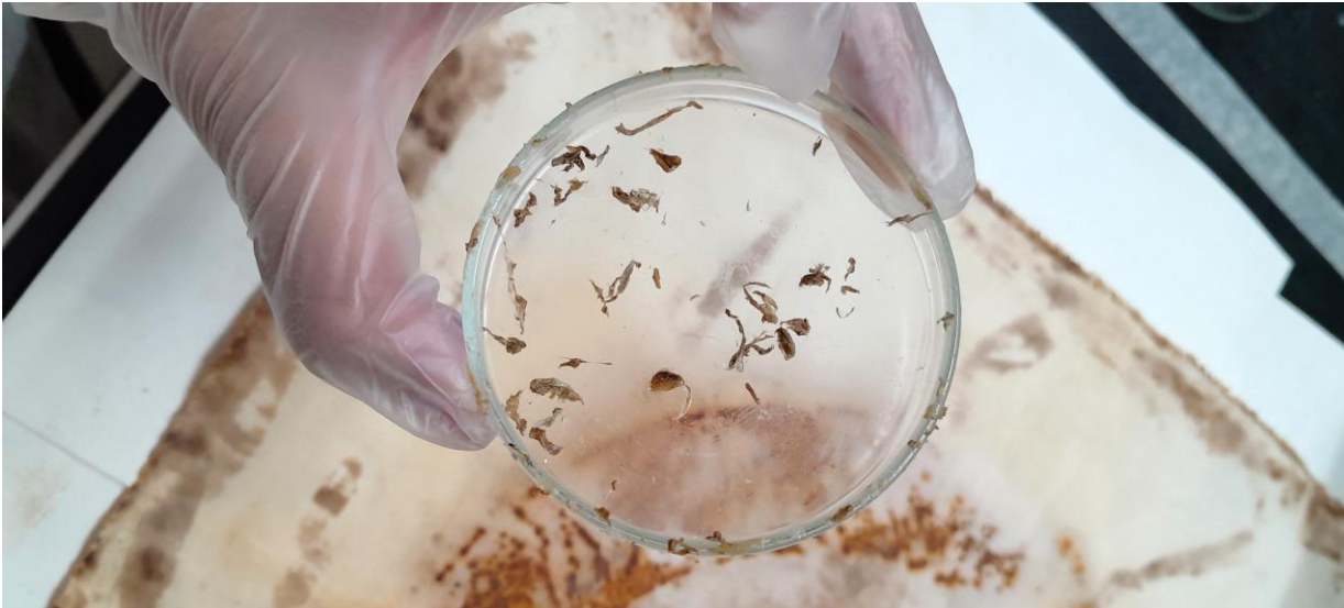
Figura 6. Aglomerado de adesivo removido após inchamento com acetato de isoamila.
