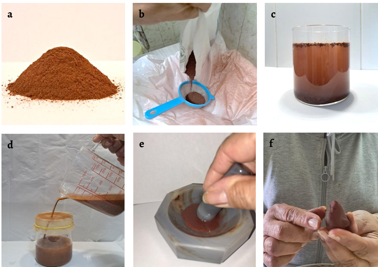
Figura 3. Fases de purificación de la arcilla de Vidiago hasta convertirla en pella de bol: a) secado a temperatura ambiente; b) criba gruesa; c) purificación en agua; d) tamizado mediante media fina; e) molienda con mortero de ágata; f) elaboración manual de la pella.
